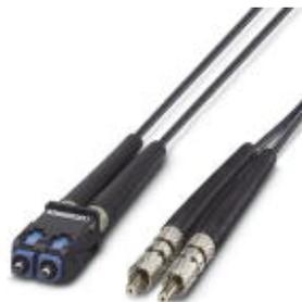
Готовый оптоволоконный кабель, Break-Out, полимерное волокно 980/1000 мкм, разъемы SC-RJ/IP20 и FSMA/IP20, для монтажа внутри распределительных шкафов, кабель подходит для применения под открытым небом при условии наличия защиты от УФ-излучения, длина: 5 м
