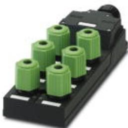
Коробка датчика и исполнительного элемента, применение: Стандартн., тип подключения: QUICKON, 0,34 мм<sup>2</sup> ... 0,75 мм<sup>2</sup>, количество гнезд: 6, полюсов: 4, гнездо для платы: один ряд, индикатор состояния: есть, NPN; подключение магистрального кабеля: Пружинные зажимы 180°, экранировка: нет
