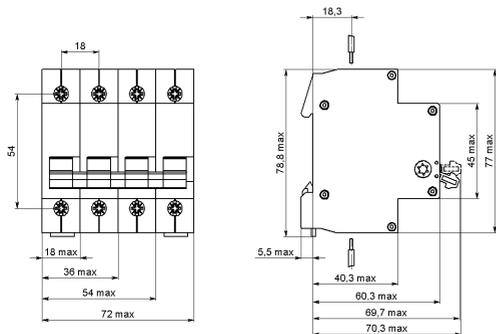
Рисунок Б.1 - Габаритные, установочные, присоединительные размеры выключателей.
