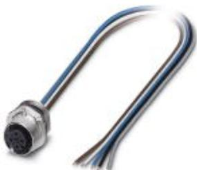
Встраиваемая розетка для датчика / исполнительного устройства, 5-полюсная, M12-SPEEDCON, с механическим ключом А-типа, монтаж с передней части стенки / резьбовое крепление с M16, с гибким проводником 1 м (изоляция из ТРЕ), 5 x 0,14 мм<sup>2</sup>
