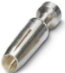
Механически обработанный обжимной контакт 2,5ег, гнездовой, отдельный, сечение 4,00 мм<sup>2</sup>, с покрытием серебром
