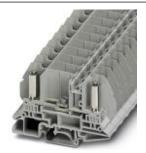
Измерительная клемма с ползунковым размыкателем, номинальное напряжение: 800 В, номинальный ток: 50 А, тип подключения: Болтовые клеммы, длина: 79,9 мм, ширина: 13 мм, цвет: серый, монтаж: NS 35/7,5, NS 35/15, NS 32, номинальное напряжение: 800 В
