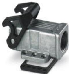
Приборный корпус D7, с одной защелкой, материал: Из алюминия, методом литья под давлением, стойкий к морской воде, длина кабеля: 1, боковое, высота: 27,9 мм, кабельный ввод: без, патрубок: да, 1x M20, Стандартн., открытое дно
