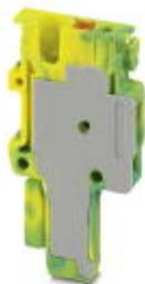
Штекер, номинальное напряжение: 500 В, номинальный ток: 17,5 А, тип подключения: Зажимы Push-in, количество точек подсоединения: 1, полюсов: 1, сечение: 0,14 мм<sup>2</sup> - 1,5 мм<sup>2</sup>, AWG: 26 - 14, ширина: 3,5 мм, высота: 31,3 мм, цвет: желто-зел.
