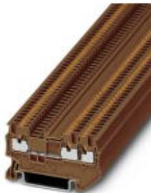
Проходные клеммы, номинальное напряжение: 500 В, номинальный ток: 17,5 А, тип подключения: Зажимы Push-in, количество точек подсоединения: 3, сечение: 0,14 мм<sup>2</sup> - 1,5 мм<sup>2</sup>, AWG: 26 - 14, ширина: 3,5 мм, высота: 30,5 мм, цвет: коричневый, тип монтажа: NS 35/7,5, NS 35/15
