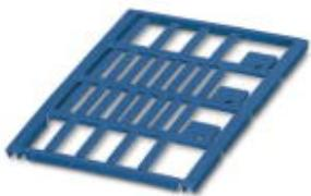
Маркер для кабелей, возможен заказ: в пластинах, синий, надписи в соответствии с требованиями заказчика, тип монтажа: вставить, диапазон диаметра кабеля: 1,5 ... 35 мм, размер маркировочного поля: 23 x 4 мм
