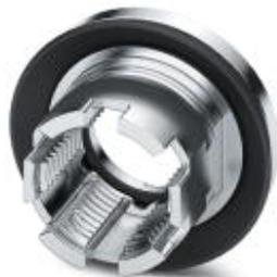
Резьбовая втулка M12 с компенсацией допусков, для прямых гнездовых контактных вставок M12 с возможностью поверхностного монтажа SMD. Подходит для передних панелей с толщиной стенки от 2,3 мм до 3,0 мм
