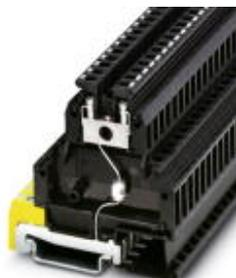
Клеммный блок с газонаполненным разрядником для грубой защиты от импульсных перенапряжений между корпусом клеммного модуля и монтажной рейкой, отдельное подключение РЕ, номинальное напряжение: 110 В AC, устанавливается на рейку NS 35/7,5, ширина клеммного модуля: 6,2 мм, высота клеммного модуля: 69 мм
