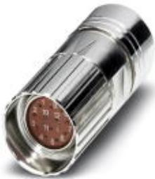
Кабельный соединитель, прямой, Винтовой зажим, M23, полюсов: 17, тип контактов: Розетка, Обжим, экранирован.: есть, диапазон диаметра кабеля: 5 мм ... 13,2 мм
