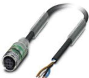
Кабель для датчика / исполнительного элемента, 4-полюсн., ПВХ, черный RAL 9005, свободный конец, к Гнездо прямое M12, А-кодирование, с 2 светодиодных, длина кабеля: 10 м
