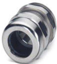
Кабельный ввод, материал резьбового соединения: латунь, никелированный, наружный диаметр кабеля 32 мм ... 42 мм, экранировка: есть, резьба соединительной части: M63 x 1,5, цвет: серебристый, с уплотнительным кольцом
