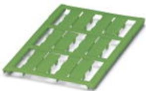
Маркировка для проводов, Пластина, зеленый, без маркировки, маркируется с помощью: BLUEMARK ID COLOR, BLUEMARK ID, BLUEMARK CLED, PLOTMARK, CMS-P1-PLOTTER, тип монтажа: защелкивание, диапазон диаметра кабеля: 5 ... 7,5 мм, размер маркировочного поля: 23 x 8 мм
