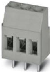
Клеммы для печатной платы, номинальный ток: 24 A, номинальное напряжение: 400 В, размер шага: 5,08 мм, полюсов: 7, тип подключения: Винтовой зажим с натяжной гильзой, монтаж: Пайка волной припоя, направление подключения, проводник/печатная плата: 0 °, цвет: сигнальный серый
