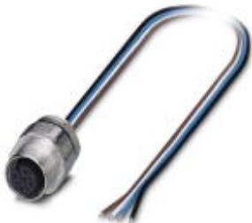
Встраиваемая розетка для датчика / исполнительного элемента, 4 контакта, M12, с механическим ключом А-типа, монтаж с передней части стенки / резьбовое крепление с Pg9, позиционируемая, с гибким проводом 0,5 м (изоляция из TPE), 4x 0,34 мм<sup>2</sup>
