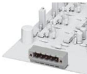
Корпусная часть для печатных плат, номинальный ток: 12 A, расчетное напряжение (III/2): 320 В, полюсов: 5, размер шага: 5,08 мм, цвет: агатовый серый, поверхность контакта: Золото, монтаж: Пайка волной припоя, Позолоченные контакты / цвет: серый RAL 7038
