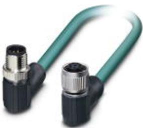
Сетевой кабель, Ethernet CAT5 (1 Гбит/с), 8-полюсн., PUR без галогенов, цвет морской воды RAL 5021, экранирован., Штекеры угловой M12 SPEEDCON / IP67, механические ключи: A, к гнездо угловой M12 SPEEDCON / IP67, механические ключи: A, длина кабеля: 0,5 м
