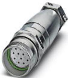
Переходные соединители, соединительная часть с резьбой Pg9, прямой, экранирован.: есть, Винтовой зажим, M23, Полюсов: 8+1, тип контактов: Розетка, Подключение пайкой, диапазон диаметра кабеля: 7,5 мм ... 9,5 мм
