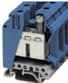
Проходные клеммы, номинальное напряжение: 1000 В, номинальный ток: 125 А, тип подключения: Винтовые зажимы, количество точек подсоединения: 2, сечение: 0,75 мм<sup>2</sup> - 50 мм<sup>2</sup>, AWG: 18 - 1/0, ширина: 15,1 мм, цвет: синий, тип монтажа: NS 35/7,5, NS 35/15, NS 32
