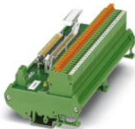
16-кан. модуль со светодиодом, для комп. Honeywell C300. Управление модулем осуществляется по цепи управления, подключаемой с помощью 37-полюсного разъема D-SUB или 50-полюсного FLK. Со стороны подключения полевых устройств предусмотрен винтовой зажим (1+, 1-,...16+,16-) с ножевым разъединителем. Ширина модуля: 170 мм
