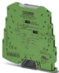
Разделительный усилитель MCR с гальванической развязкой трех цепей, с конфигурируемым входом / выходом, для гальванической развязки и преобразования аналоговых сигналов в диапазоне милливольт, однополярные, а также биполярные с винтовыми клеммами, предварительно не сконфигурирован
