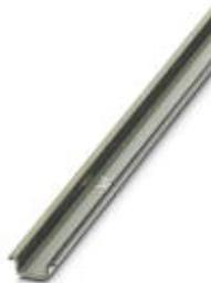
Несущая рейка без перфорации, Стандартный профиль, ширина: 15 мм, высота: 5 мм, согласно EN 60715, материал: Сталь, оцинкован., пассивирован., длина: 2000 мм, цвет: серебристый
