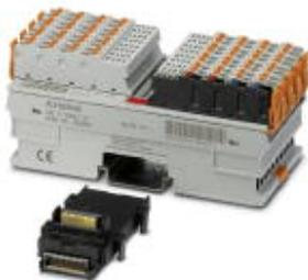
Axioline F, Модуль цифрового вывода, Цифровые выходы: 64, 24 В DC, 500 мА, способ подключения: 1-проводной кабель, скорость передачи данных в локальной шине: 100 Мбит/с, степень защиты: IP20, с цокольным модулем шины и штекерами Axioline F
