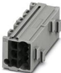
Сотовые клеммы, без нажимной кнопки, номинальное напряжение: 500 В, номинальный ток: 17,5 А, сечение: 0,14 мм<sup>2</sup> - 2,5 мм<sup>2</sup>, AWG: 14 - 26, тип подключения: Зажимы Push-in, полюсов: 1, количество подключений: 6, ширина: 11 мм, длина: 12,2 мм, цвет: серый, цвет элементов подключения: черный, монтаж: крепление защелками на адаптере для монтажной рейки, крепление защелками на фланце крышки
