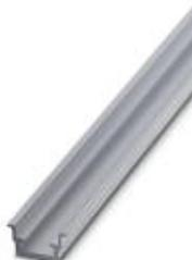
Несущая рейка без перфорации, Стандартный профиль, ширина: 35 мм, высота: 15 мм, соотв. EN 60715, материал: Алюминий, без покрытия, длина: 1000 мм, цвет: серебристый
