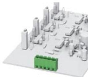
Корпусная часть для печатных плат, номинальный ток: 12 А, расчетное напряжение (III/2): 320 В, полюсов: 6, размер шага: 5,08 мм, цвет: зеленый, поверхность контакта: Золото, монтаж: Пайка волной припоя, Позолоченные контакты / цвет: зеленый RAL 6021
