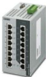
Управляемый коммутатор Ethernet соответствует стандартам МЭК 61850-3 и IEEE 1613. Предоставляет 16 портов RJ45 для 10/100 Мбит/с при рабочей температуре от -40°C ... +70°C.
