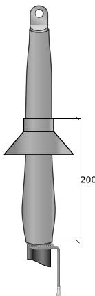
**п. 9 выполняется только при монтаже муфт наружной установки марки 1ПКНТ-10**
