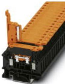
Клемма с рычажными размыкательями, номинальное напряжение: 500 В, номинальный ток: 16 А, тип подключения: Винтовые зажимы, сечение: 0,5 мм<sup>2</sup> - 6 мм<sup>2</sup>, AWG: 20 - 10, длина: 58 мм, ширина: 8,2 мм, цвет: черный / оранжевый, монтаж: NS 35/7,5, NS 35/15, NS 32, номинальное напряжение: 500 В
