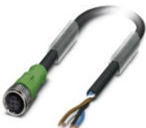
Кабель для датчика / исполнительного элемента, 4-полюсн., PUR, темно-серый RAL 7021, свободный конец, к Гнездо прямое M12, А-кодирование, длина кабеля: 15 м
