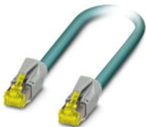
Патч-кабель, CAT6A, 4 пары, экранированный, нескрещенное (прямое) соединение, с обоих концов смонтированы соединители RJ45/IP20, материал внешней оболочки: полиуретан, длина 10 м
