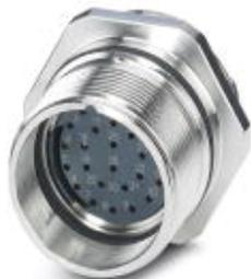
Аппаратн. соединитель, передняя стенка, прямой, Винтовой зажим, M27, полюсов: 26, тип контактов: Розетка, Подключение пайкой, Аксиальное уплотнительное кольцо, Центральное крепление, экранирован.: есть
