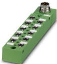
Коробка датчика и исполнительного элемента, применение: Стандартн., тип подключения: Розетка M8 металл, количество гнезд: 10, полюсов: 3, гнездо для платы: один ряд, индикатор состояния: есть, р-п; подключение магистрального кабеля: Штекерный разъем M 16 90°, экранировка: нет
