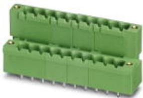
Корпусная часть для печатных плат, номинальный ток: 10 A, расчетное напряжение (III/2): 320 В, полюсов: 4, размер шага: 5 мм, цвет: зеленый, поверхность контакта: олово, монтаж: Пайка волной припоя, Возможна установка в ряд модулей с различным количеством полюсов (контактов)! Применяется вместе со штекерными частями MVSTB или FKCV и штекерами MVSTBW (или FKCVW соответственно) и MVSTBR (FKCVR). Нельзя использовать со штекерными частями TMSTBP!
