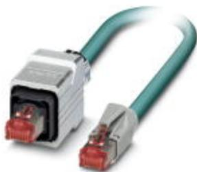
Готовый Ethernet-кабель, CAT6, экранированный, 4 пары, гибкий AWG 26 (7-проволочный), RAL 5021 (цвет морской воды), разъемы RJ45/IP67, Push-Pull, металлический корпус, и RJ45/IP20, прямая разводка, длина 5 м
