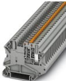
Клеммы с ножевыми размыкательями, с пусковой пластинкой и винтами для крепления контрольного штекера, номинальное напряжение: 500 В, номинальный ток: 20 А, тип подключения: Винтовые зажимы, сечение: 0,14 мм<sup>2</sup> - 6 мм<sup>2</sup>, AWG: 26 - 10, длина: 57,8 мм, ширина: 6,2 мм, цвет: серый, монтаж: NS 35/7,5, NS 35/15, номинальное напряжение: 500 В
