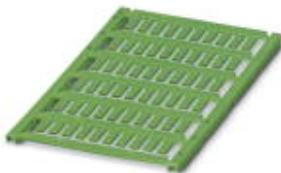
Маркировка для проводов, Пластина, зеленый, без маркировки, маркируется с помощью: TOPMARK NEO, TOPMARK LASER, BLUEMARK ID COLOR, BLUEMARK ID, BLUEMARK CLED, THERMOMARK PRIME, THERMOMARK CARD 2.0, THERMOMARK CARD, тип монтажа: вставить, диапазон диаметра кабеля: 0,6 ... 7 мм, размер маркировочного поля: 10 x 4 мм
