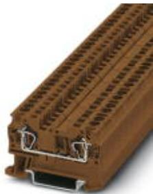
Проходные клеммы, номинальное напряжение: 800 В, номинальный ток: 32 А, тип подключения: Пружинный зажим, количество точек подсоединения: 2, сечение: 0,08 мм<sup>2</sup> - 6 мм<sup>2</sup>, AWG: 28 - 10, ширина: 6,2 мм, цвет: коричневый, тип монтажа: NS 35/7,5, NS 35/15
