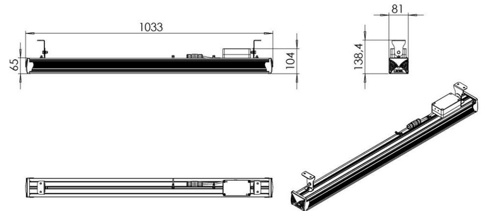
Рисунок 1 Светильник «L-industry NEW 48T/Em». Поворотный вариант
