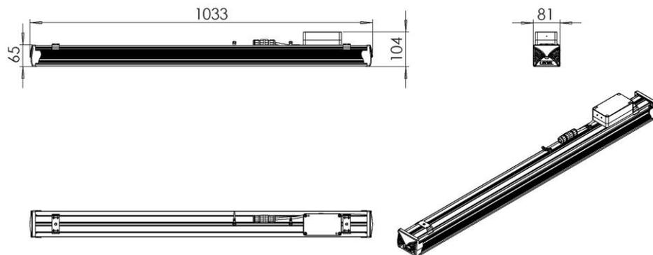
Рисунок 3 Светильник «L-industry NEW 48T/Em». Задвижной вариант
