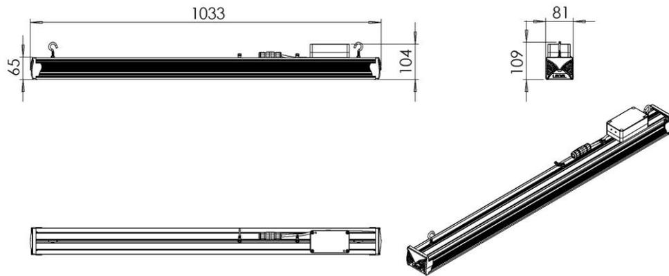
Рисунок 2 Светильник «L-industry NEW 48T/Em». Подвесной вариант
