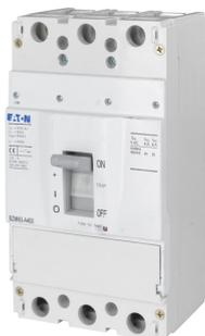
**Автоматический выключатель 400А, номинальное напряжение 400/415 В (AC), 3 полюса, откл. способность 36кА**
