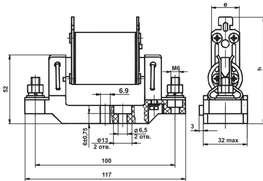
Рисунок В.5 – Основания (держатели) предохранителей ППН Габарит 00, исполнение 1
