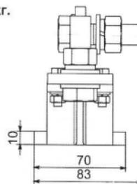
Рисунок В.7 - Основания (держатели) предохранителей ППН габариты 00, 0, 1, 2, 3, 4 исполнения 2
