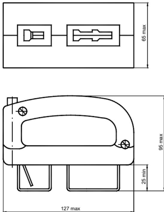
Рисунок В.8 – Рукоятка съема для смены плавких вставок
