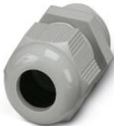
Кабельный ввод, материал резьбового соединения: PA, наружный диаметр кабеля 5 мм ... 10 мм, экранировка: нет, резьба соединительной части: Pg11, цвет: светло-серый, RAL 7035
