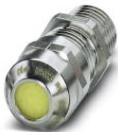
Кабельный ввод, материал резьбового соединения: латунь, никелированный, применение: Ex, наружный диаметр кабеля 5 мм ... 10 мм, экранировка: есть, резьба соединительной части: M16 x 1,5, цвет: серебристый, с уплотнительным кольцом
