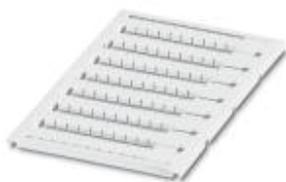
Маркировка для клеммных модулей, Пластина, белый, без маркировки, маркируется с помощью: BLUEMARK ID COLOR, BLUEMARK ID, BLUEMARK CLED, PLOTMARK, CMS-P1-PLOTTER, тип монтажа: крепление в плоских пазах для табличек, для клемм шириной: 5,2 мм, размер маркировочного поля: 5 x 7 мм
