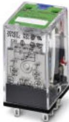
Вставное промышленное реле с силовыми контактами, 2 переключающих контакта, кнопка тестирования, светодиодный индикатор состояния, безынерционный диод, механический индикатор коммутационного положения, полярность A1+, A2-, входное напряжение 12 В постоянного тока
