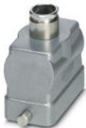
Сальниковый корпус, для крепления одной защелкой, высота 56 мм, с резьбовым соединением, 1 x Pg16, прямое подсоединение кабеля
