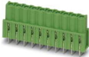
Корпусная часть для печатных плат, номинальный ток: 12 А, расчетное напряжение (III/2): 320 В, полюсов: 5, размер шага: 5,08 мм, цвет: зеленый, поверхность контакта: олово, монтаж: Пайка волной припоя
